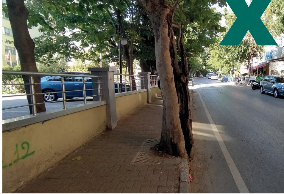
Ağaç köklerinin çevresinde sert zemin uygulaması yapılmamalı, ağaçların çevresinde min. 90 cm yumuşak zemin boşluk bırakılmalıdır. Ağaçların kaldırım kenarında olması durumunda dikilik ile kaldırım bordürü arasında 20 cm mesafe olmalıdır.
